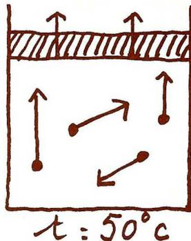
La vitesse des molécules a augmenté, le piston est frappé plus violemment. Donc surpression. Donc le piston va monter jusqu'à atteindre un nouvel équilibre.
