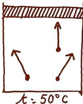
La vitesse des molécules est toujours la même, mais le piston a monté. Les molécules ont plus de place. Le piston est en équilibre car d'un côté il reçoit des chocs nombreux et faibles, et de l'autre il reçoit moins de chocs, mais plus violents.
