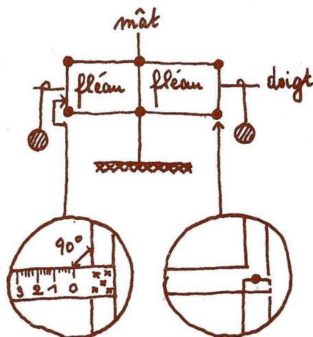
Fixation rigide du doigt (agrafes, colle etc.). Le doigt est gradué.
