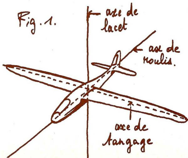
L'élément stabilisateur fixe est l'empennage horizontal, ou plan fixe horizontal, situé à l'arrière du fuselage. Toute variation de l'angle d'attaque de l'aile provoque sur l'empennage horizontal une portance, négative ou
