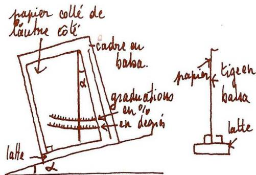
Il suffit de poser l'appareil sur le plan incliné, et le « fil à plomb » dévie de l'angle de ce plan incliné. Pour graduer le papier, j'ai utilisé un rapporteur et une règle pour la graduation en degrés et à partir de celle-ci et avec une table trigonométrique, la graduation en % (sinus de l'angle  $\times$  100).
