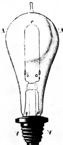
Lampe à incandescence à filament de carbone
