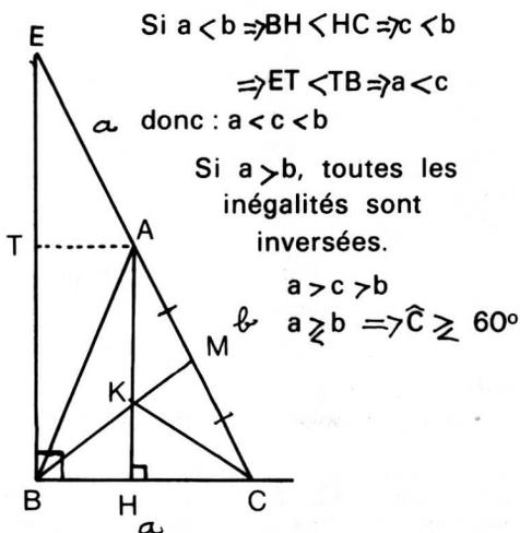
Si on donne le côté BC fixe, quel est l'ensemble des points A ? Il s'obtient en menant  $BE \perp BC$  et en prenant A sur CE tel que EA = BC. La courbe obtenue que l'on peut tracer par points est appelée CONCHOÏDE de la droite BE pour le point C et la longueur BC.
