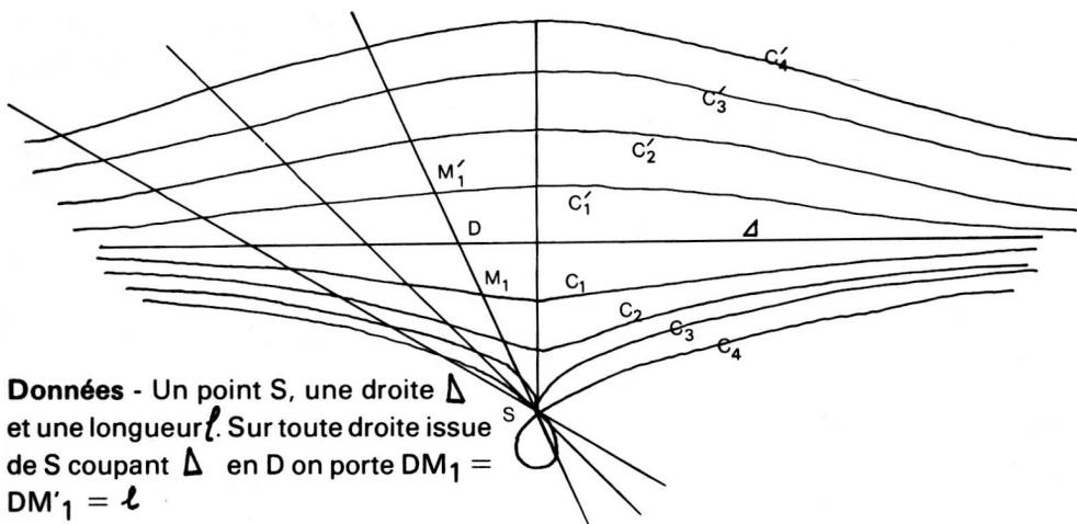
**Données** - Un point S, une droite  $\Delta$  et une longueur  $l$ . Sur toute droite issue de S coupant  $\Delta$  en D on porte  $DM_1 = DM'_1 = l$
