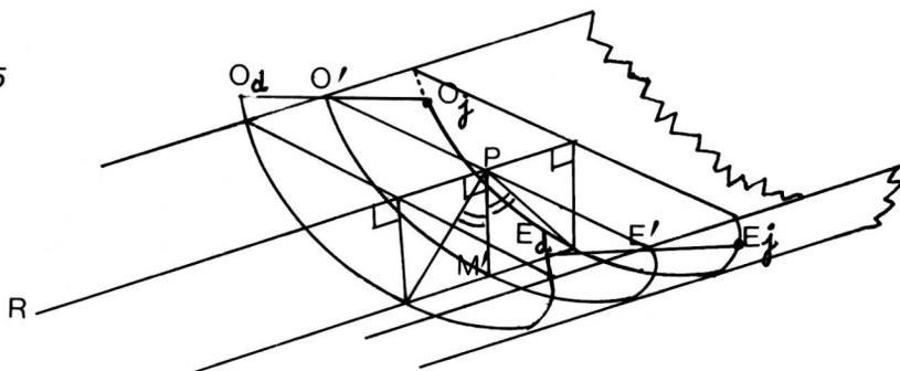
1 - arcs d'ellipse :  $O_d O' O_j$ ,  $E_d E' E_j$  intersections du cylindre avec le plan horizontal de P
